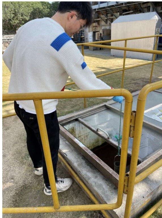
废水总排口监测
